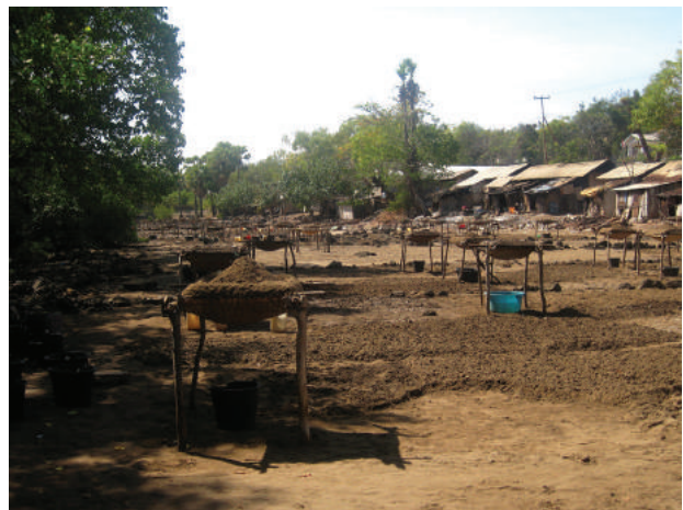
Penyaringan pasir garam di Desa Lahayong, Flores Timur, NTT
